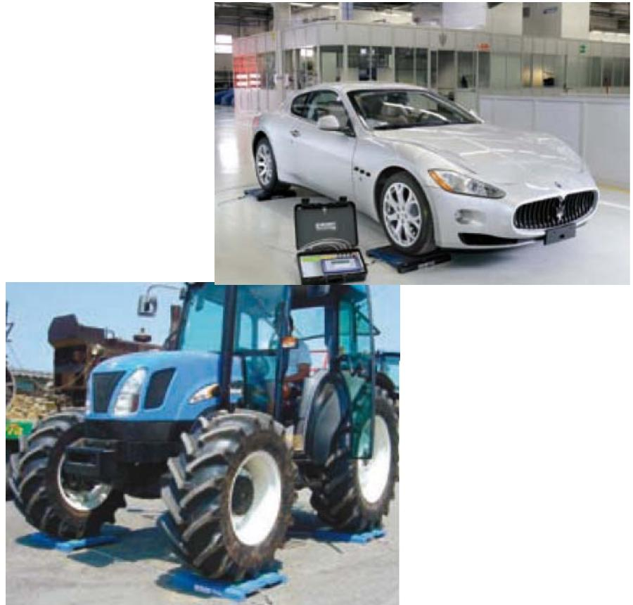
**Sistem mobilnih vaga za vaganje vozila s niskoprofilnim platformama koje se spajaju na isti pokazni uređaj .**
